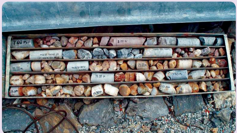
รูปที่ 7 การเจาะสำรวจเพื่อเก็บตัวอย่างแกนกลางเขื่อน
