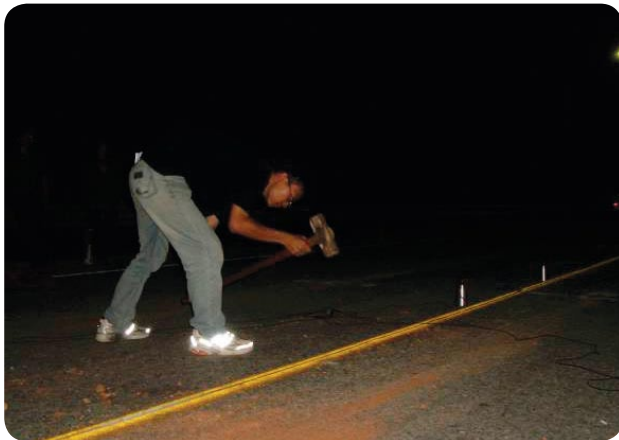
รูปที่ 8 การทดสอบ SASW เพื่อตรวจสอบค่า Vs ของวัสดุตัวเขื่อนและฐานราก
