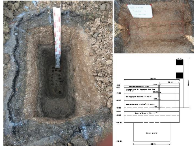
รูปที่ 9 การชุดเปิดบ่อทดสอบและ Mapping ทิศทางรอยแตก
