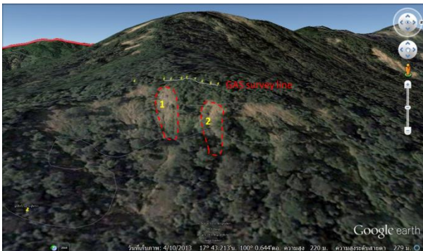
รูปที่ 10 แนวการวัดเสียงน้ำใต้ดิน เหนือรอยดินถล่ม ม่อนน้ำชา อ.ลับแล จ.อุตรดิตถ์
