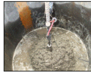
ภาพที่ 42 ลักษณะเครื่องมือ Non-Stress Strain Meter และการติดตั้ง
