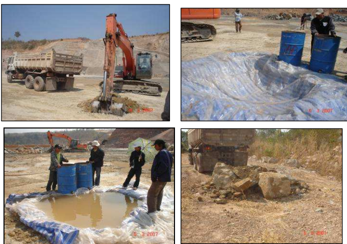
ภาพที่ 19 ทดสอบความแน่น(Density Test) โดยวิธีแทนที่ด้วยน้ำ
