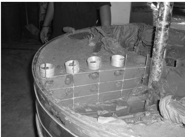
ภาพที่ 13 เก็บตัวอย่างดินหา Water Content
