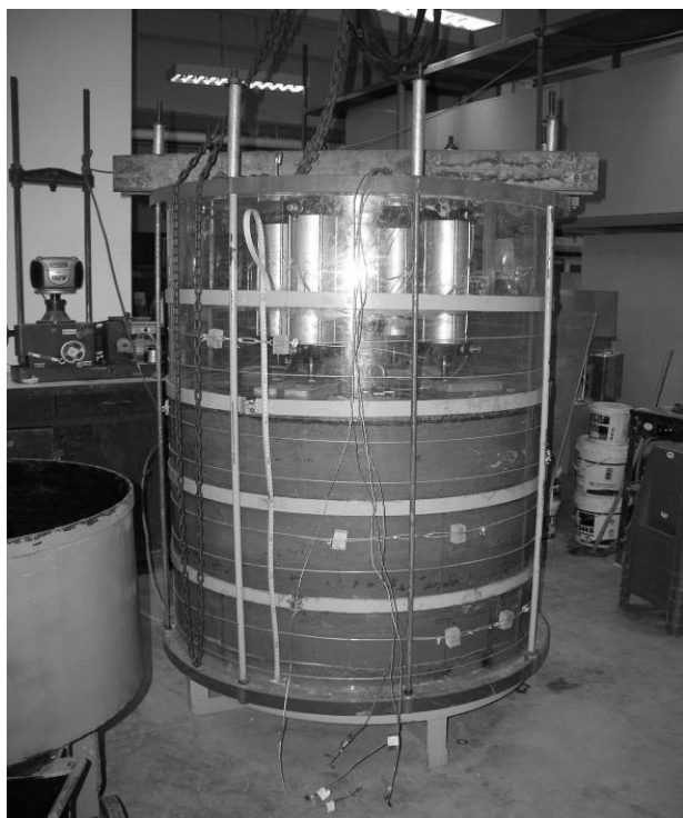
ภาพที่ 8 กระบวนการ Consolidation เพื่อจำลองสภาพดิน
