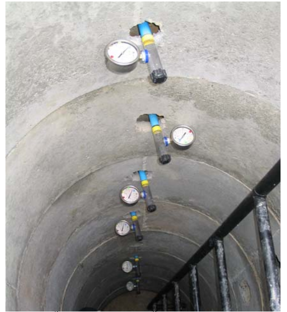
รูปที่ 4 การติดตั้งเครื่องมือวัดแรงดึงน้ำในมวลดิน (Tensiometer)
