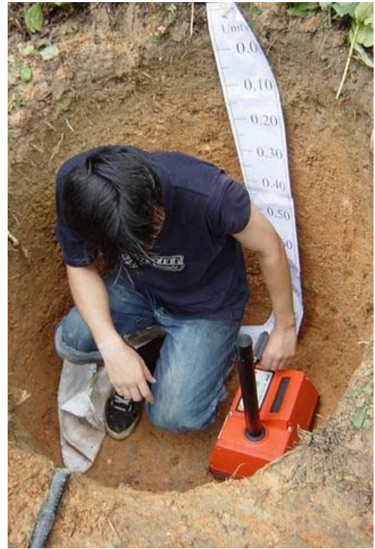
รูปที่ 1 แสดงการทดสอบด้วยเครื่อง Nuclear Density
