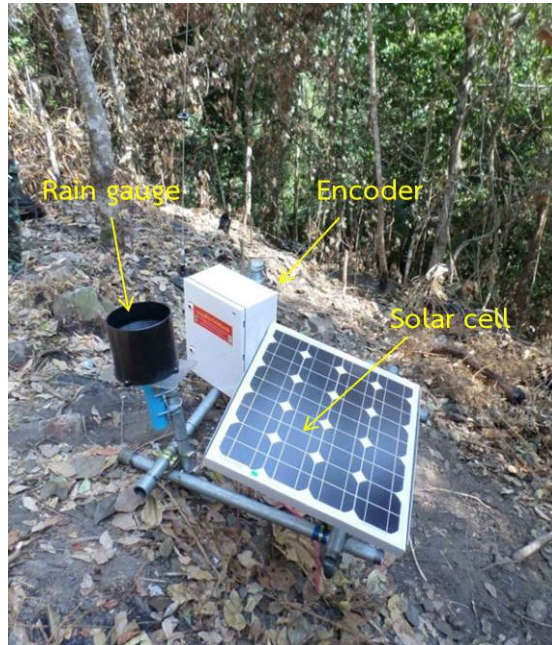
รูปที่ 5-7 สถานีตรวจวัดปริมาณน้ำฝนและกล่องรับสัญญาณ (encoder box) บริเวณพื้นที่ต้นน้ำ ที่มา : สุทธิศักดิ์ และคณะ (2558)
