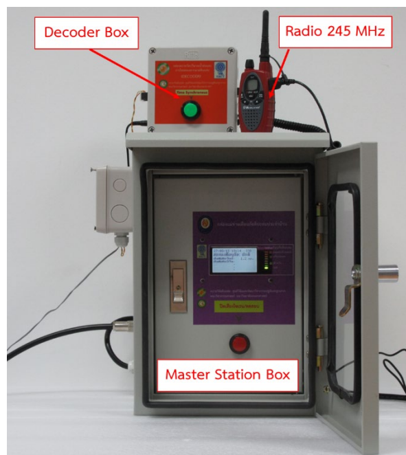
รูปที่ 5-4 กล่องถอดรหัสสัญญาณ (decoder box) ที่เชื่อมต่อกับเครื่องประมวลผลแม่ข่าย
