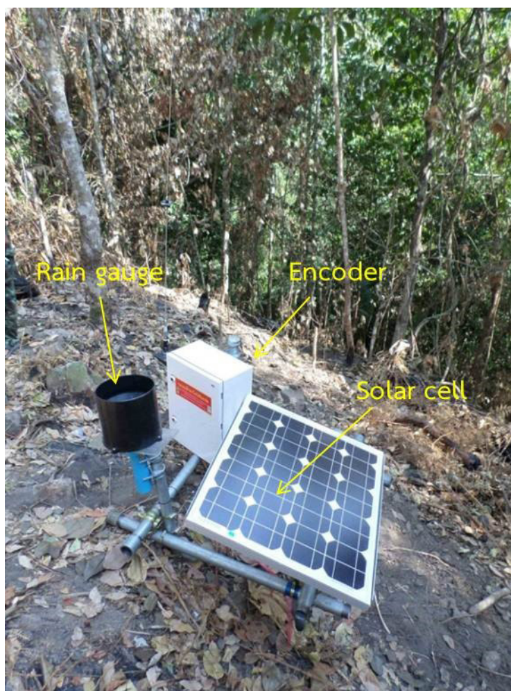
รูปที่ 29 สถานีตรวจวัดปริมาณน้ำฝนและกล่องรับสัญญาณ (encoder box) บริเวณพื้นที่ต้นน้ำ
