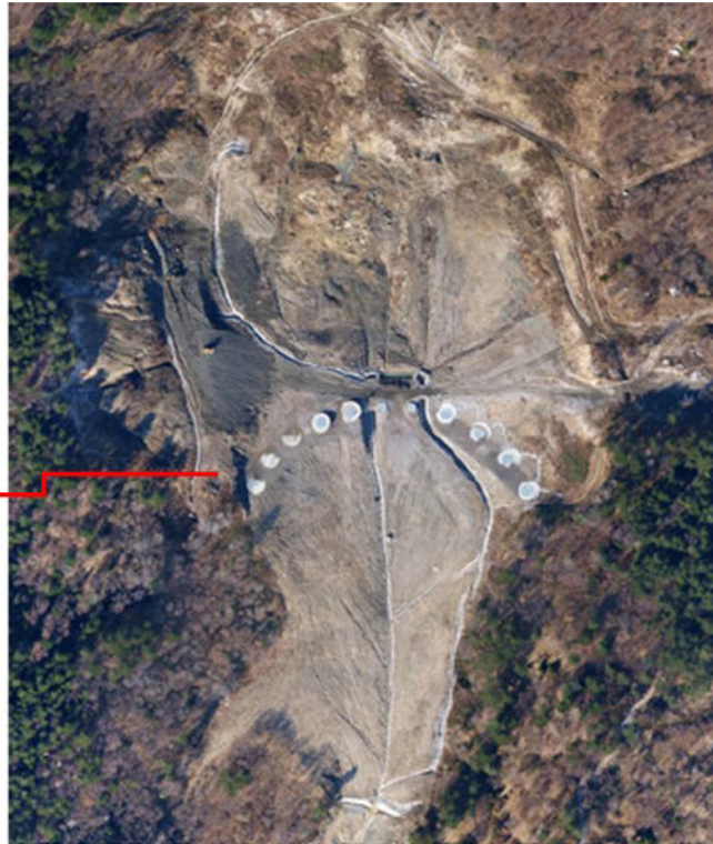
รูปที่ 7 การติดตั้งระบบ Shaft Drain สำหรับระบบน้ำใต้ดิน
