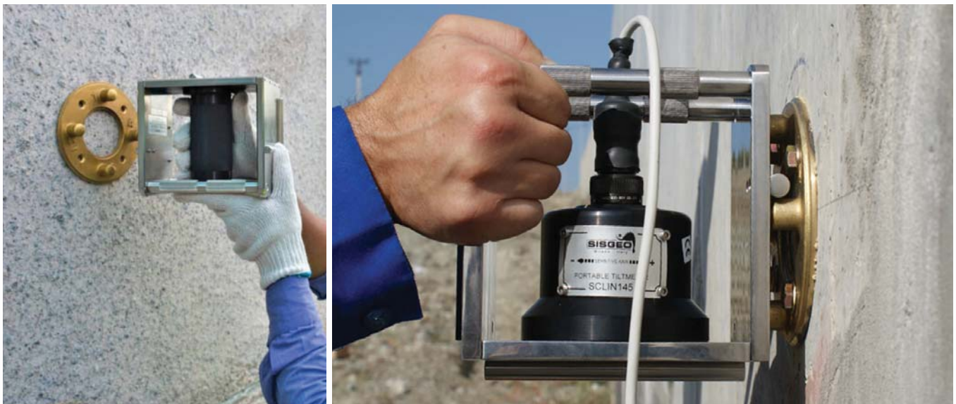
รูปที่ 6 เครื่องมือสำหรับวัดความเอียง (Tiltmeter)
