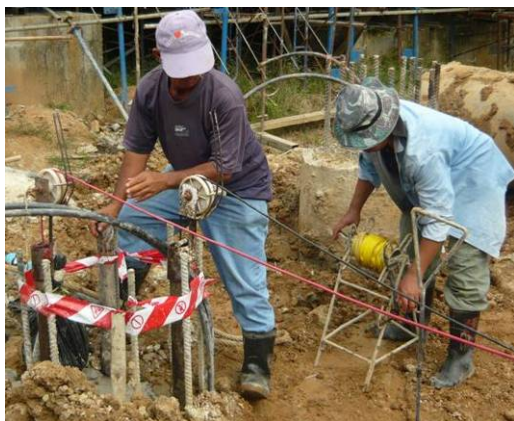
รูปที่ 41 การทดสอบ Sonic Logging เพื่อตรวจสอบความสมบูรณ์ของเสาเข็มหลังการเทและแข็งตัว
