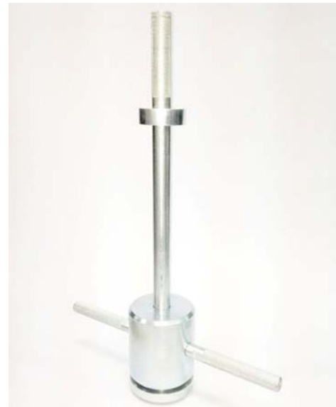
(ข) ชุดอุปกรณ์เก็บตัวอย่างดินคงสภาพ
