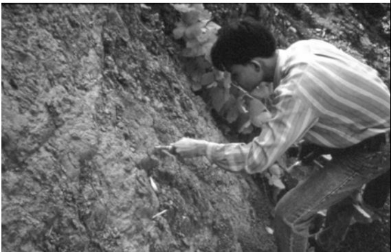
การทดสอบ Pocket Penetrometer ในสนาม
